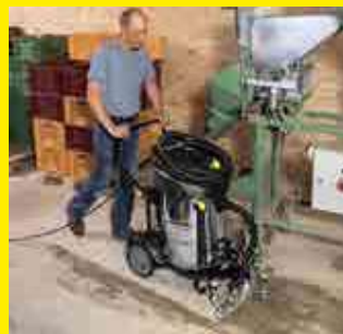
Speciale zuigers: ontworpen voor het opzuigen van grote hoeveelheden vloeistof en grof vuil.
